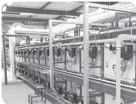
Роликовая печь обжига в керамической промышленности
