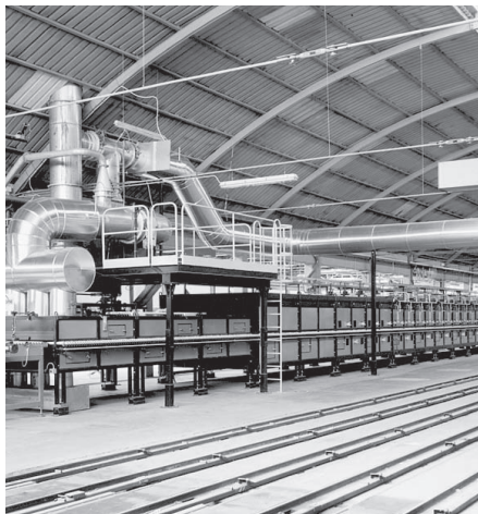
Роликовая печь обжига в керамической промышленности
