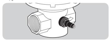
Прибор поставляется со штуцером для замера входного давления p<sub>u</sub>, вмонтированном в корпус прибора.
