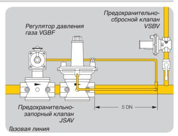
Предохранительно-сбросной клапан VSBV для сброса давления во время его кратковременного превышения с целью предотвращения несанкционированных срабатываний предохранительно-запорного клапана.
