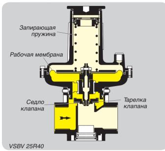
Предохранительно-сбросной клапан VSBV, если давление ниже настроенного, усилием пружины находится в закрытом состоянии.
