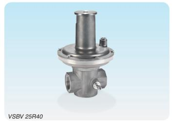
Предохранительно-сбросной клапан для сброса давления во время его кратковременного превышения в системах регулирования газа с целью предотвращения несанкционированных срабатываний предохранительно-запорного клапана. В случае перетечек газа в результате недостаточно плотного закрытия регуляторов давления VSBV снижает повысившееся сверх нормы давление.
