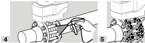
6 После успешного завершения проверки на герметичность удалите фланцевую заглушку или откройте газовый электромагнитный клапан за дисковым затвором.
