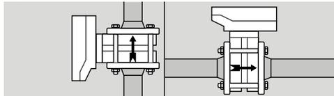
В случае монтажа дискового затвора с ограничителем (BVH..A) мы рекомендуем вертикальное положение дискового затвора с направлением потока снизу вверх, чтобы предотвратить образование конденсата и накопление грязи на ограничителе.
