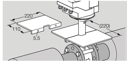
При температуре среды > 250 °C (482 °F) для защиты от перегрева используйте теплозащитную пластину.
